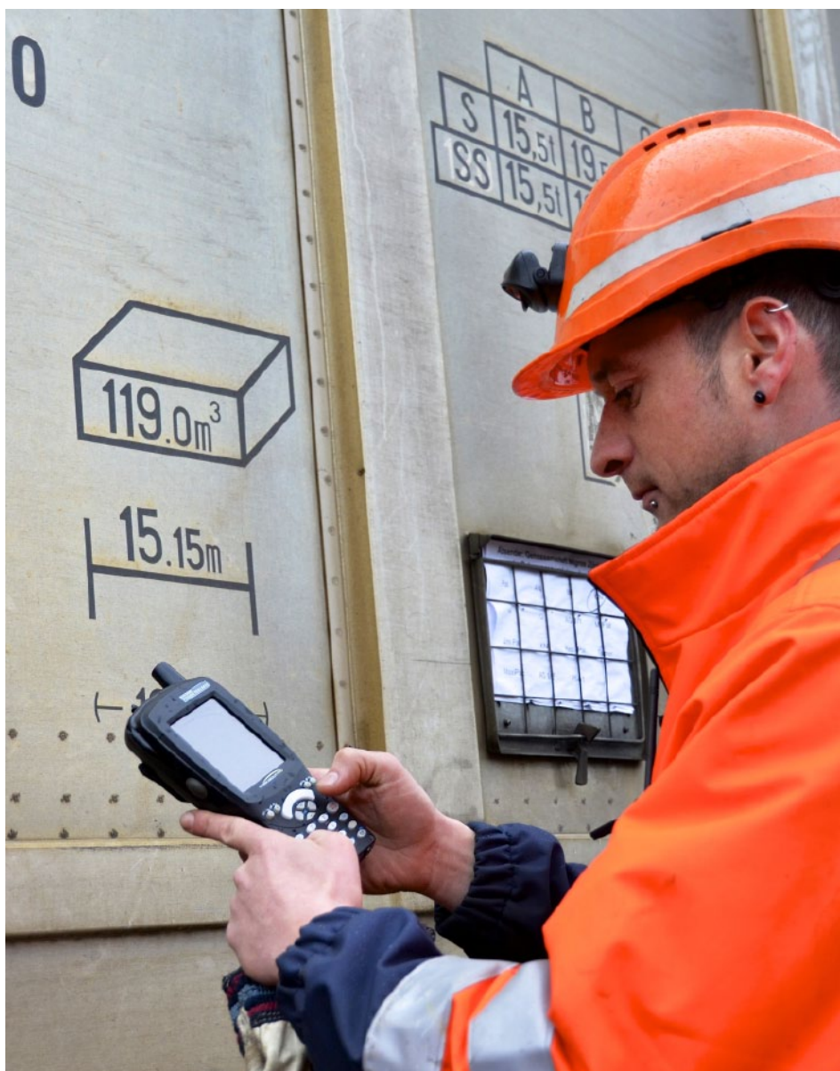
Links: Mit einem Fingerdruck steuert RCP-Spezialist Schildknecht die 80 Tonnen schwere Am 843. Oben: Die Daten jedes Waggons werden mobil erfasst und per Handynetz an die Zentrale übermittelt.
